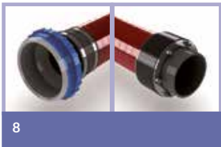
8 D / GPD Erste Seite zum Anschluss an eine Dichtpackung. Zweite Seite mit GPD Gummi-Press-Dichtung zum Anschluss an eine Kernbohrung oder ein Futterrohr.
