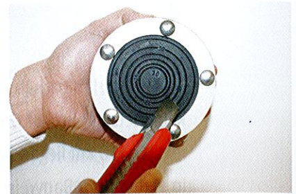
Mit dem Cuttermesser kann die Dichtung auf das benötigte Maß eingeschnitten werden.
